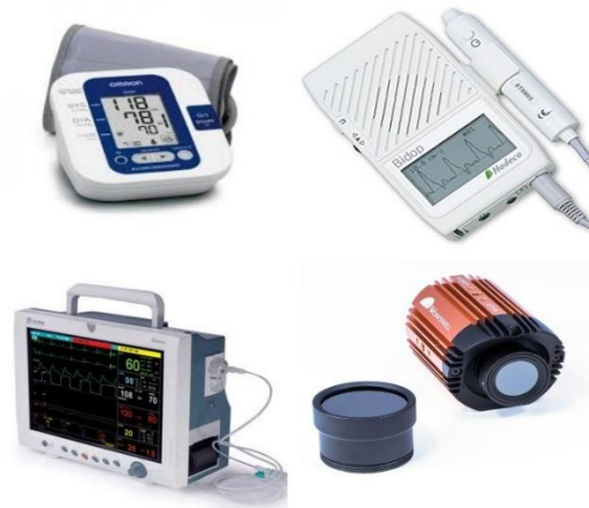
Obrázok 18 Všetky prístroje použité pri meraní hemodynamických parametrov, zľava hore digitálny tlakomer, ultrazvukový prístroj, patientský monitor s pulzným oxymetrom a infračervená termokamera
