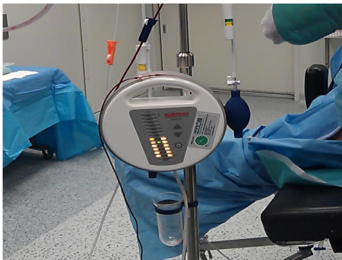
Obrázek č. 5 - Průtokový ohřev infuzních a transfuzních roztoků typu Biegler BW 685
