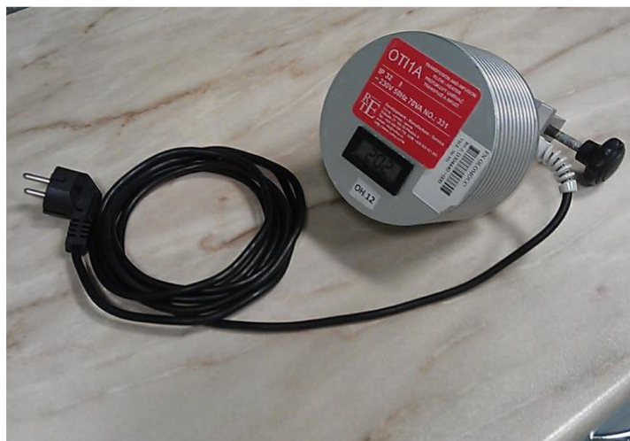
Obrázek č. 4 – Průtokový ohřev infuzních a transfuzních roztoků typu OTI A1
