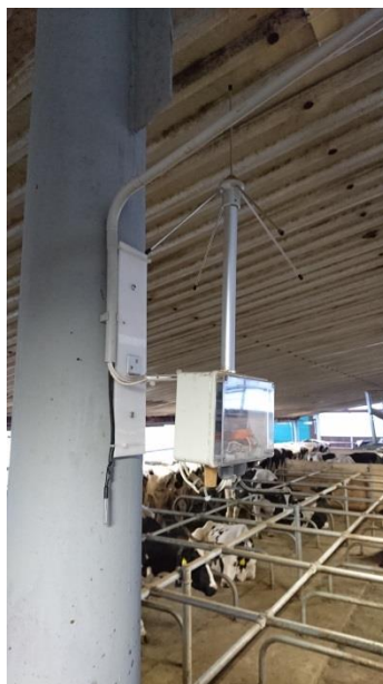
Obrázek 24 – Čidlo DS18B20 umístěné v prostoru stáje
