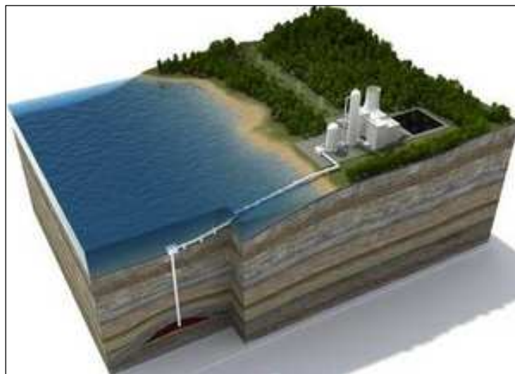
Řez geologií při akumulaci stlačeným vzduchem
