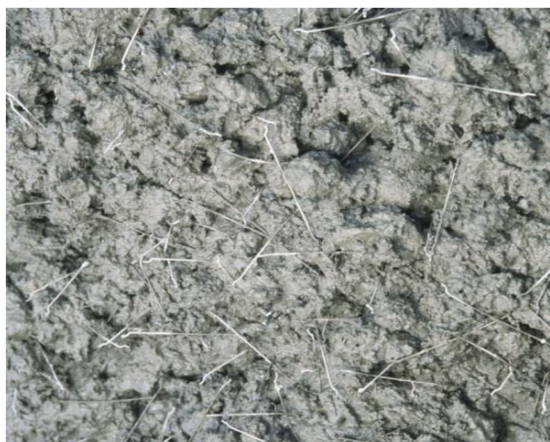
Obrázek 1 Beton s rozptýlenou ocelovou výztuží [5]
