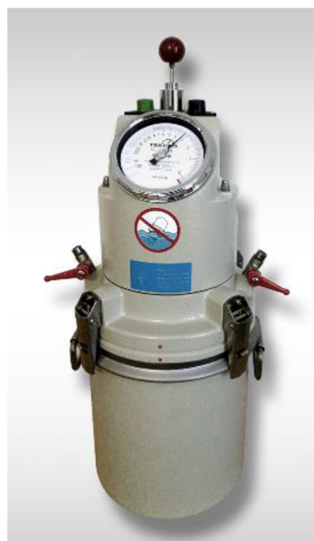
Obrázek 17 Laboratorní přístroj pro měření vzduchu v betonu [39]
