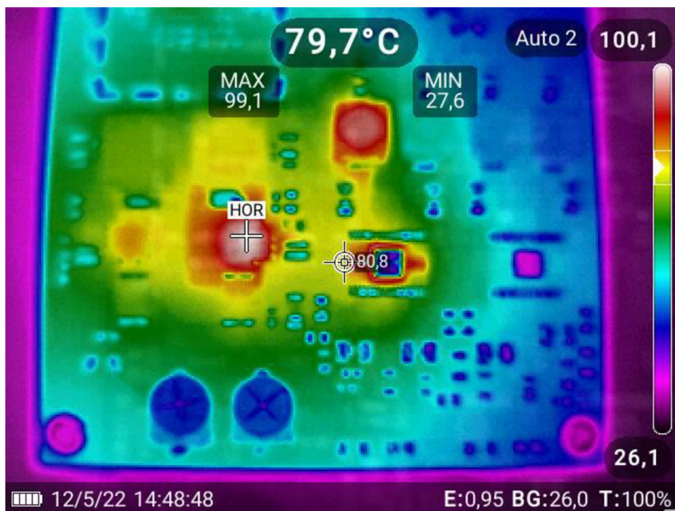
Obrázek 2.12 Detail zahřivaného místa zvyšujícího měniče před kalibrací a úpravě hodnoty registru CHx_ISLOPE
