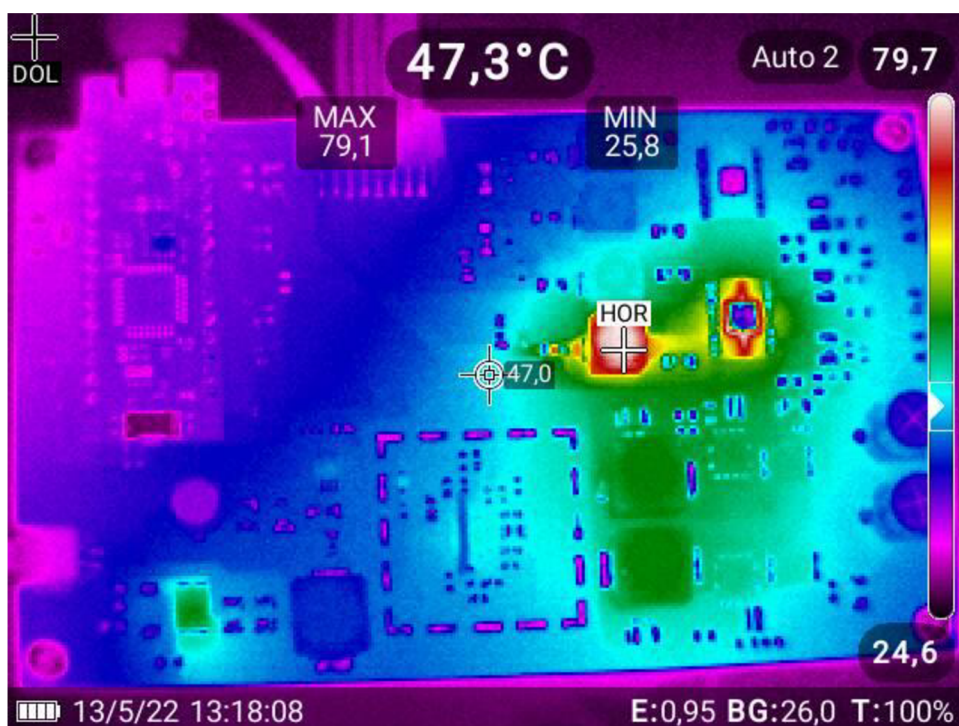
Obrázek 2.13 Detail zahřivaného místa zvyšujícího měniče před kalibrací a úpravě hodnoty registru CHx_ISLOPE
