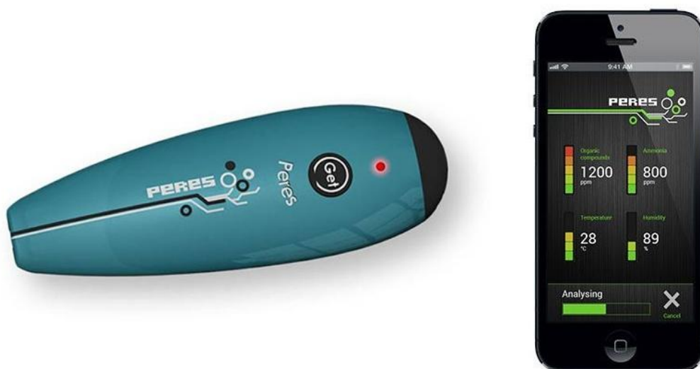
Obr. 11: Peres - Přenosný elektrický nos určující čerstvost masa [14]
