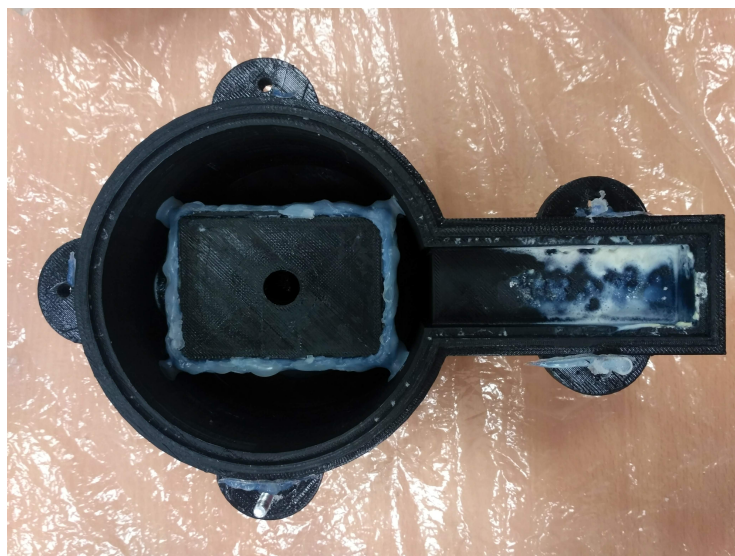
Obrázek 7.1: Znečištění vnitřního prostoru hmotnostního průtokoměru dojeným mlékem
