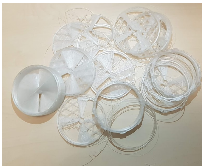
Obrázek 7.3: Narušení soudržnosti nádoby
