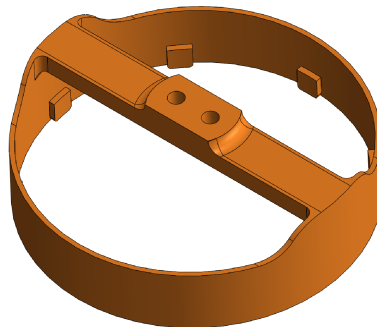
Obrázek 6.11: Spojka nádobky a tenzometrického snímače
