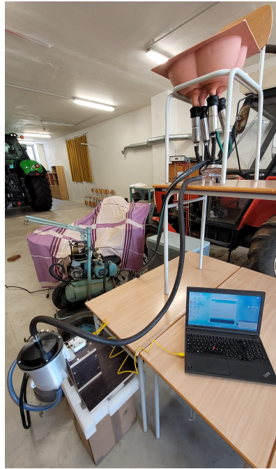
Obrázek 6.27: Test hmotnostního průtokoměru v laboratoři.
