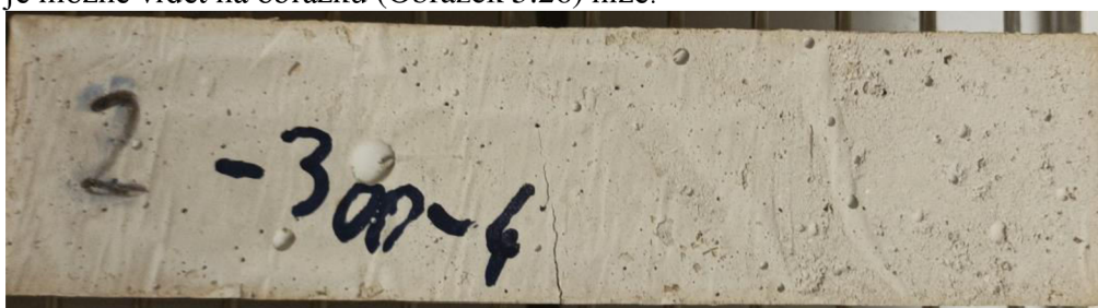
Obrázek 5.26: Fotografie vzorku reálné směsi vysušené při 300 °C
