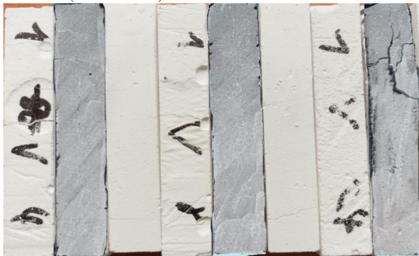
Obrázek 5.13: Vzorky modelové směsi gelu vypálené po odformování
