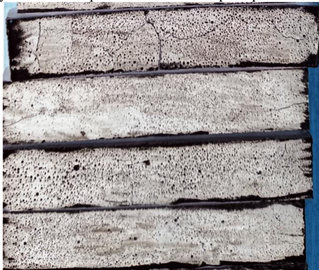
Obrázek 5.11: Vypálené vzorky modelové směsi křemičitého solu po 24 h gelace, sušené při 200 °C (horní 2) a 300 °C (dolní 2)
