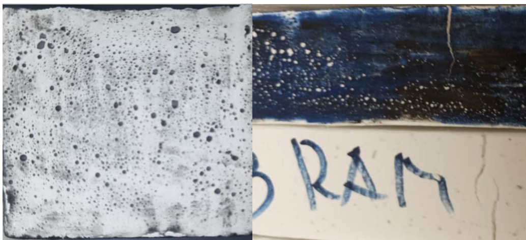
Obrázek 5.25: Fotografie vzorku s viditelnými póry po výpalu (vlevo) a vzorků s prasklinami vzniklými rychlým výpalem přímo po gelaci (vpravo).
