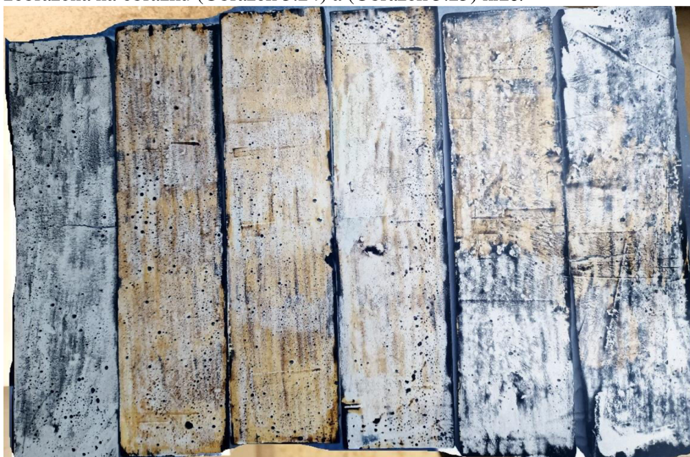
Obrázek 5.24: Obrázek povrchu vzorků a prasklin vzniklých na trámcích reálné směsi (zleva Výpal z gelu 5 °C/min, 105 °C, 150 °C, 200 °C, 300 °C, 400 °C)
