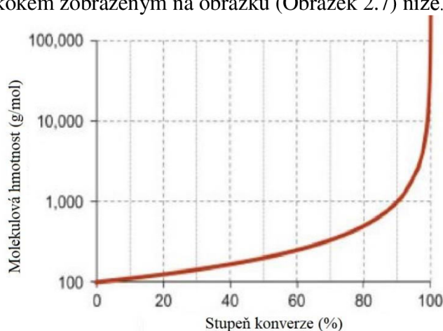
Obrázek 2.7: Graf závislosti molekulové hmotnosti na stupni konverze pro kondenzační reakce [16].
