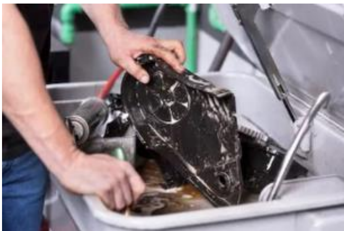
Obr. 14) Odmaštění kovů pomocí organických rozpouštědel [22]
