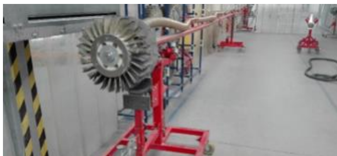
Obr. 12) Kotouče pro metodu kartáčování [17]
