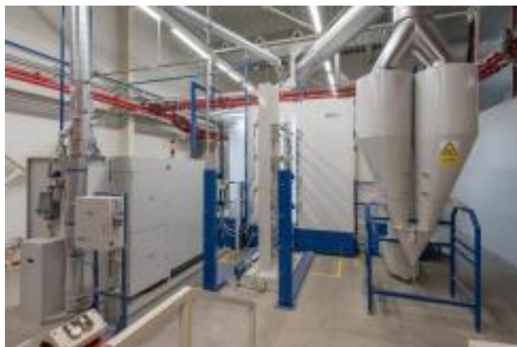
Obr. 20) Cyklon pro recyklaci práškového laku [23]
