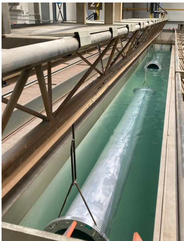
Obr. 13) Chemická předúprava materiálu u automatické linky
