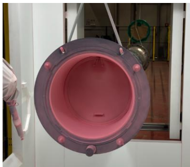
Obr. 15) Umístění maskovacího deklu ve výrobku [23]
