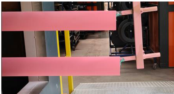
Obr. 70) Zavěšení dvou vodičů na jedné traverze
