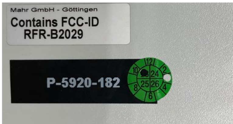
Obr. 43) Interní evidenční číslo měřidla s kontrolním štítkem
