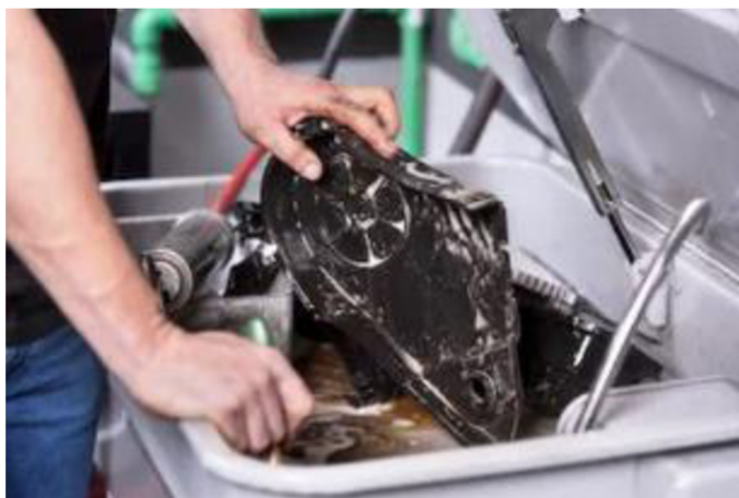
Obr. 14) Odmaštění kovů pomocí organických rozpouštědel [22]
