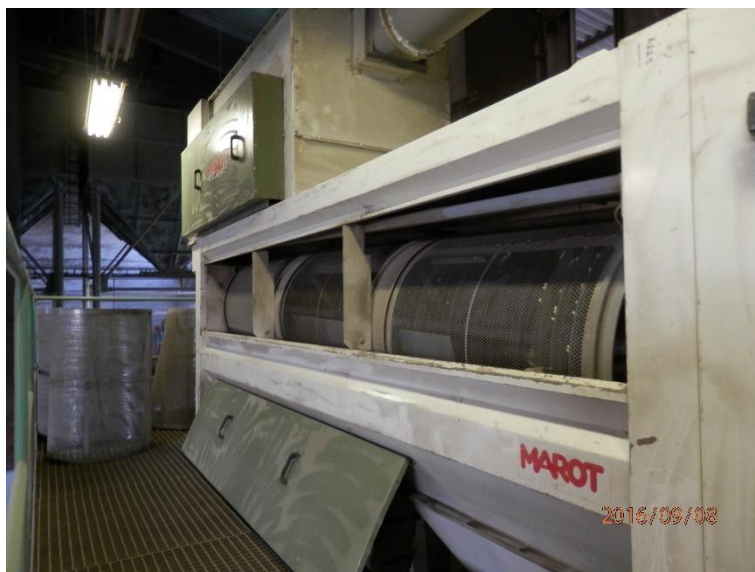
Obrázek č. 10 - Rotační buben na čističce MAROT (Prokurát, 2016).
