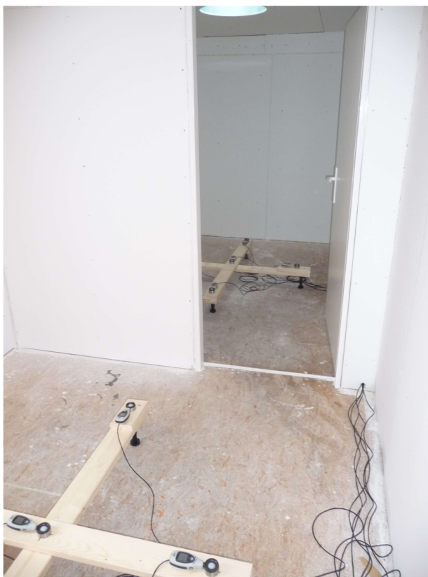
Obr. 3.3 Instalace měřícího zařízení – buňka 1 a buňka 2 odděleny vnitřní příčkou s dveřmi
