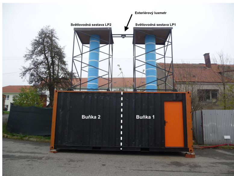
Obr. 3.1 Testovací kontejner rozdělený na dvě buňky se světlovody LP1 a LP2
