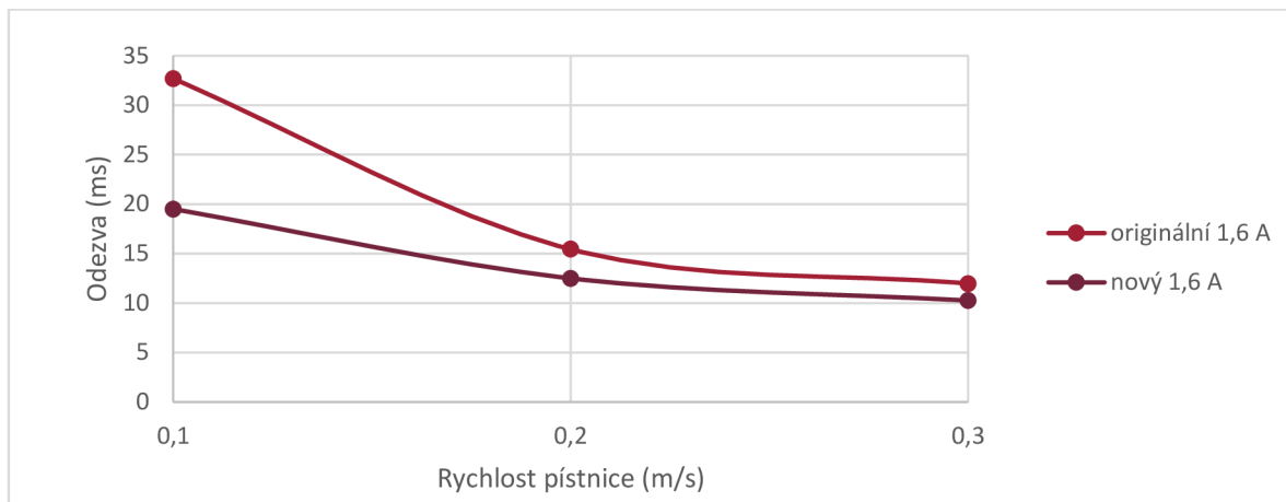
Obr. 5-27 Srovnání závislosti odezvy na rychlosti pro originální a nový ventil při zatěžování v tlaku při počátečním proudu 0,3 A
