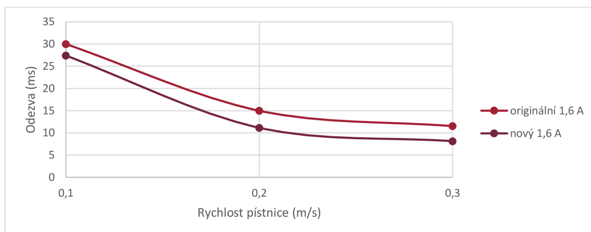
Obr. 5-25 Srovnání závislosti odezvy na rychlosti pro originální a nový ventil při zatěžování v tlaku
