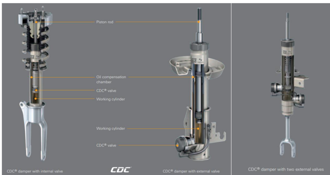
Obr. 2-6 CDC tlumiče společnosti ZF Sachs [6]
