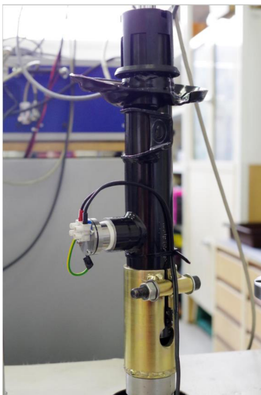
Obr. 5-18 Umístění ventilu na tlumiči
