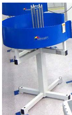
Obrázek 3.2 – Zásobník na potrubí [27].
