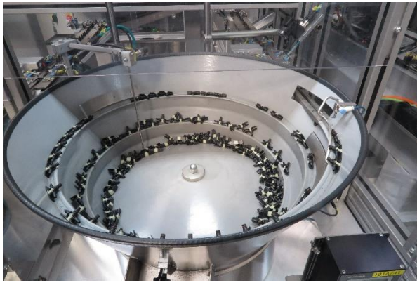
Obrázek 5.4 – Vibrační zásobník na T konetory stanice AP10.
