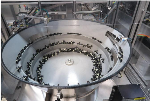
Obrázek 5.4 – Vibrační zásobník na T konetory stanice AP10.
