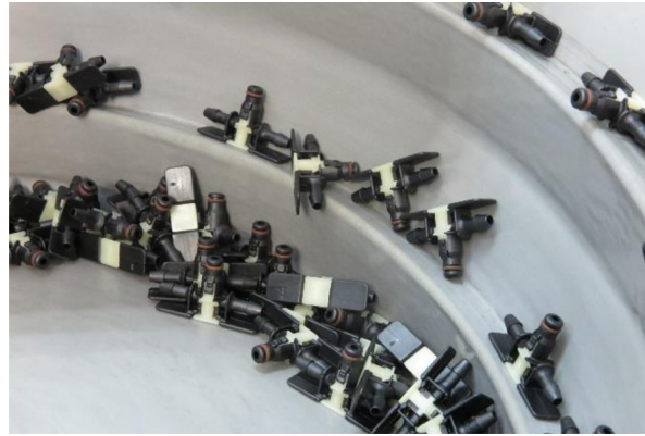
Obrázek 5.5 – Zamíchání FIFO ve vibračním zásobníku.
