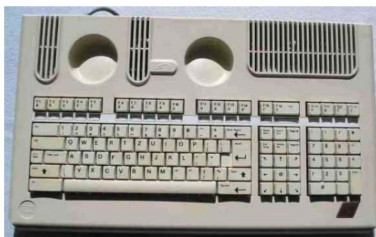
Obr. č. 18: 8bitový počítač TNS Slušovice HC8
