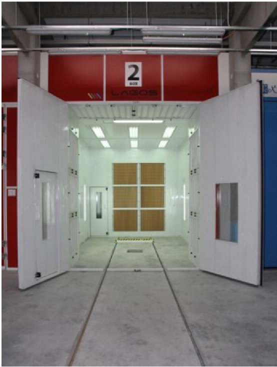
Obr. 3.6 Lakovací kabina polyurethanu LAGOS
