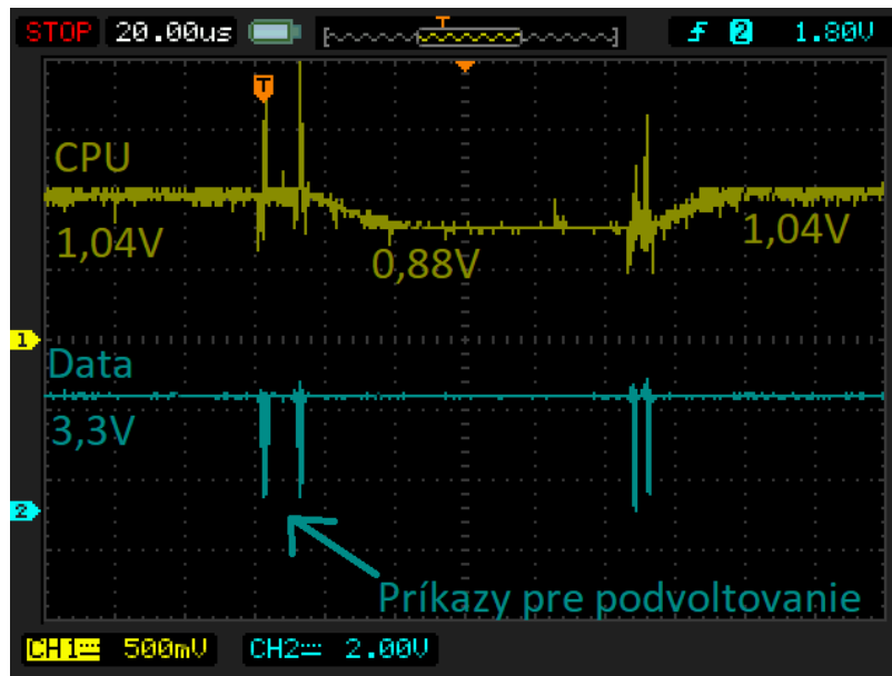
Obr. 8.7: Podvoltage CPU zaznamenané pomocou osciloskopu
