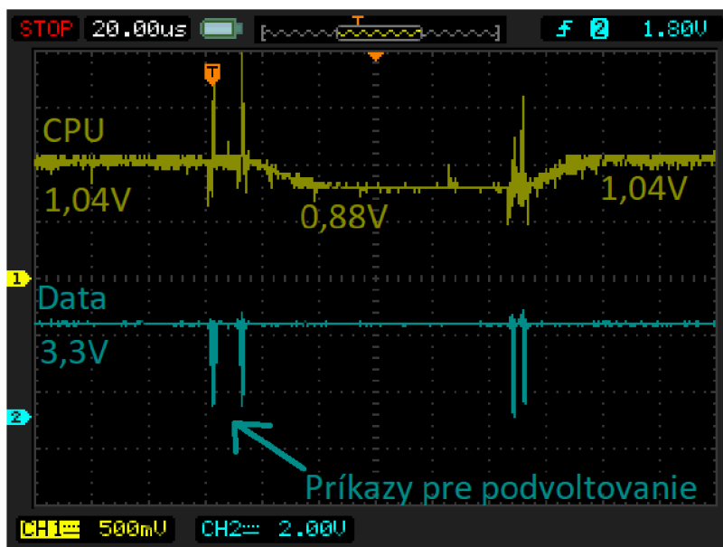
Obr. 8.7: Podvoltage CPU zaznamenané pomocou osciloskopu
