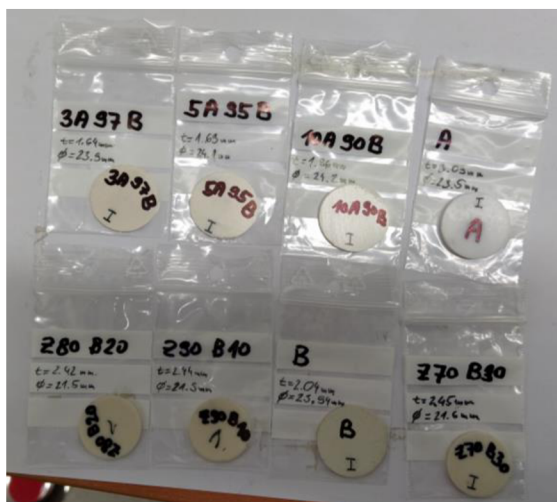
Obr. 45: Vzorky pro měření piezoelektrických vlastností; A: \text{Al}_2\text{O}_3 , B: \text{BaTiO}_3 [53].
