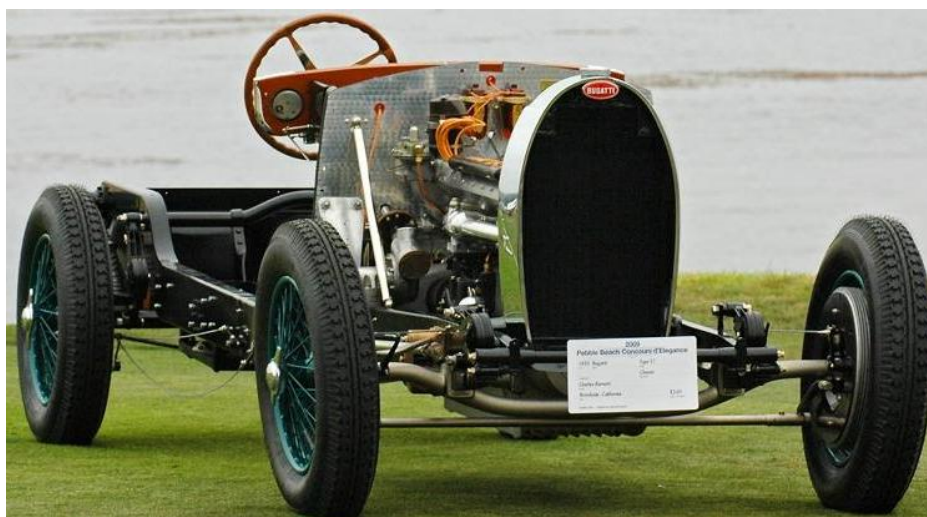
Obr. 3 Žebřinový rám se dvěma podélnými nosníky ve vozidle Bugatti typ 55 [28]
