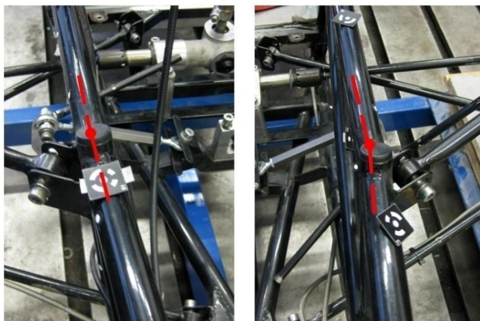
Obr. 51 Rozdíly v rozměrové přesnosti na přední části rámu formule
