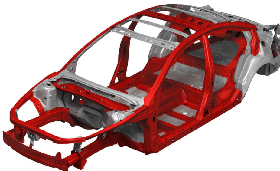
Obr. 2 Samonosná karoserie vozu Mazda 6 v provedení Skyactiv [23]
