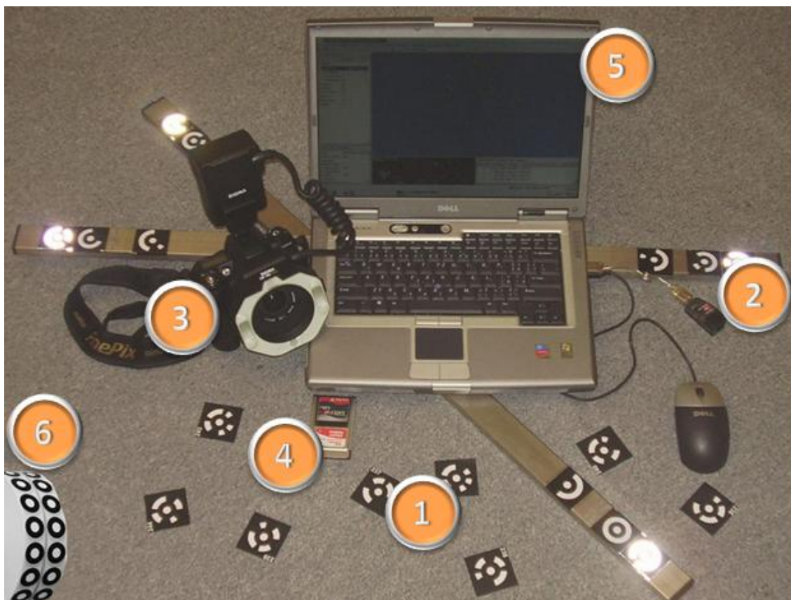
Obr. 17 Použitá měřicí technika: 1-Kódované referenční body, 2-Kalibrační tyč, 3-Digitální fotoaparát, 4-Paměťová karta PCMCIA, 5-Notebook, 6-Nekódované referenční body
