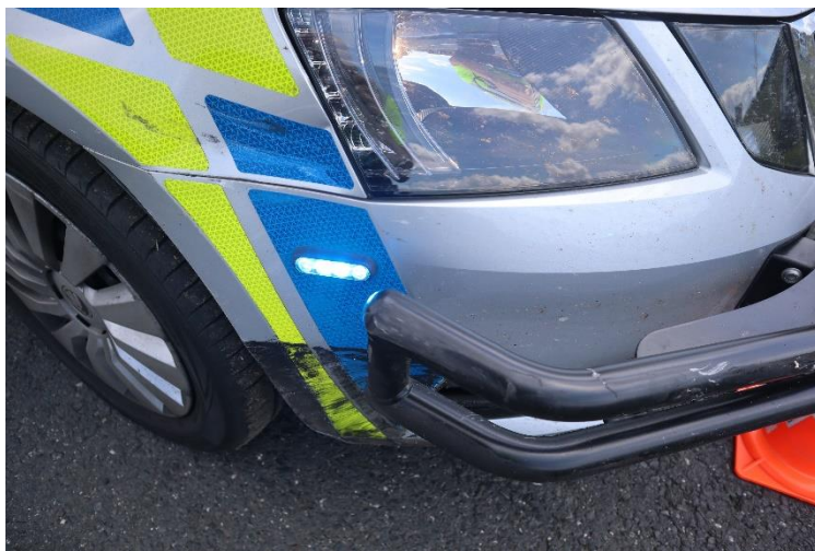
Obrázek č. 13 – poškození policejního rámu po provedení PIT manévru
