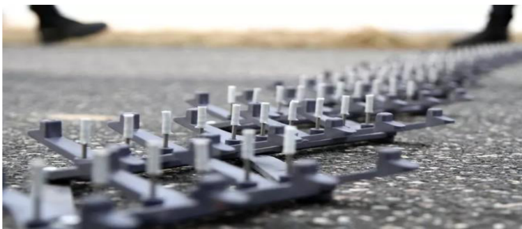
Obrázek č.1 - Detail zastavovacího pásu s hroty
