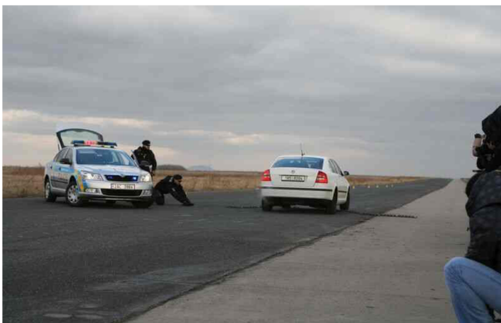
obrázek č.2 – umístění zastavovacího pásu do jízdní dráhy vozidla
