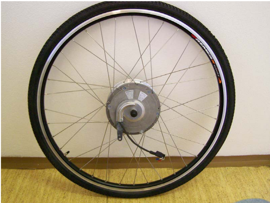
Obr.6.1.3 Stejnoseměrný motor Heinzmann – 54Nm
