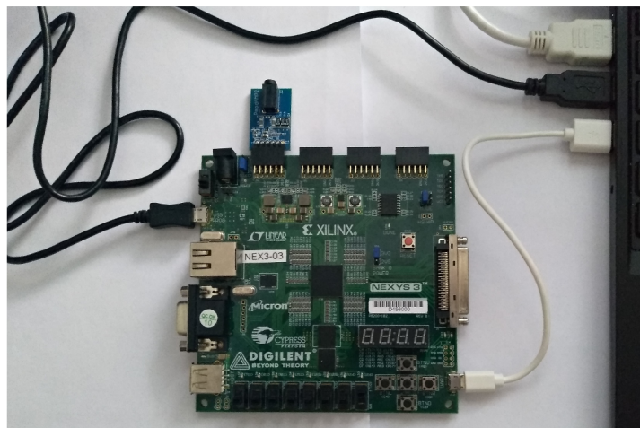
Obr. 3.8: Fotografie zapojení vývojové desky Nexys 3 s modulem Pmod AMP2
