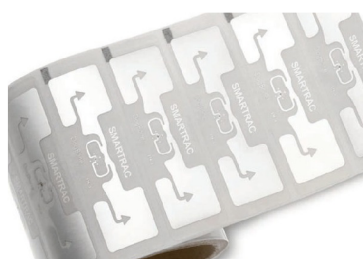
Obrázek 4.2: Jednorázový RFID pasivní čip [1].
