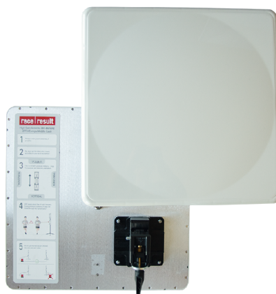
Obrázek 4.3: Anténa pro snímání čipů během závodu [17].
