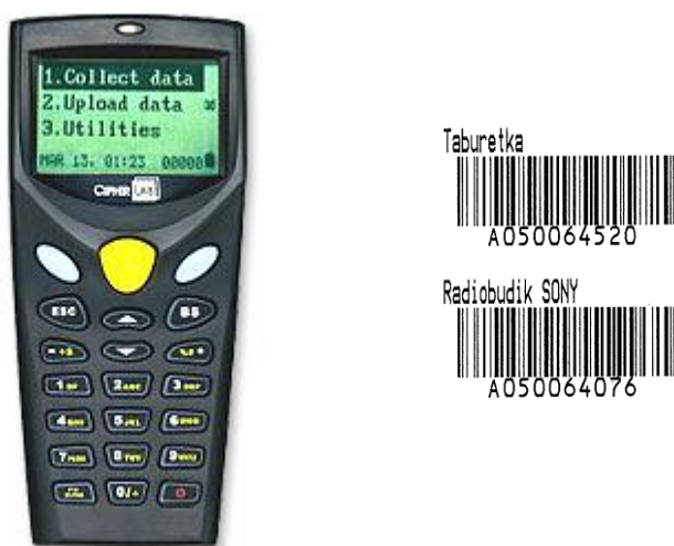
Obrázek č. 5 Snímač čárového kódu a vzhled čárového kódu ZSMV
