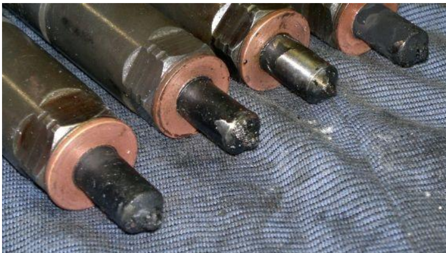
Obrázek 2.2 Nadměrně zakarbonované vstřikovače
