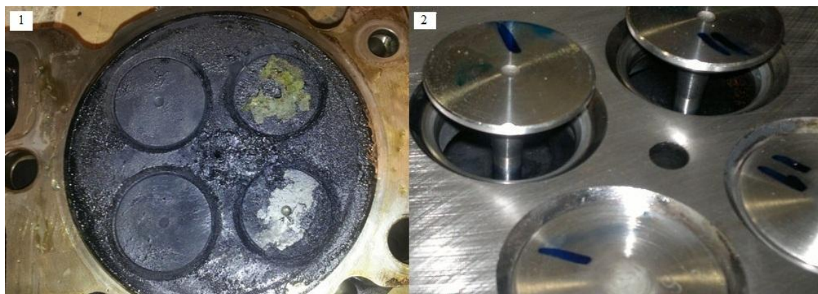
Obrázek 2.3 Podpálené ventily hlavy motoru
