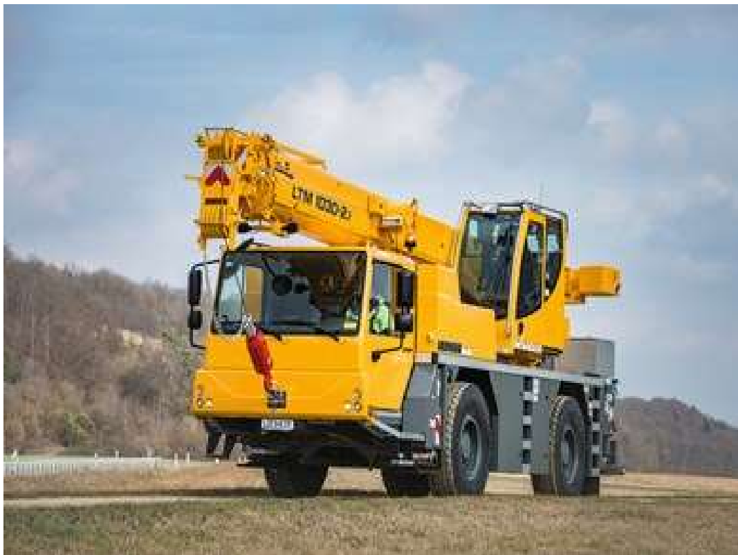
Obr. č. 46 Autojeřáb Liebherr LTM 1030 – 2.1
