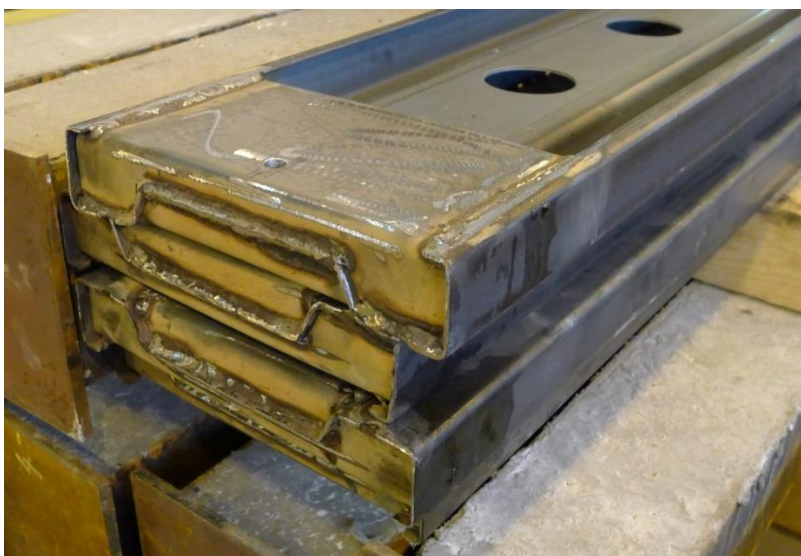
Obr. 6.13 Upravené konce zkušebních těles s navařenými tvarovanými plechy
