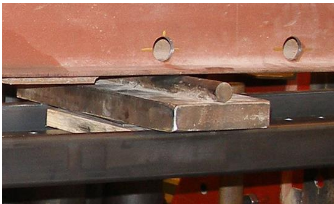
Obr. 6.23 Ocelová a dřevěná podložka – realizace
