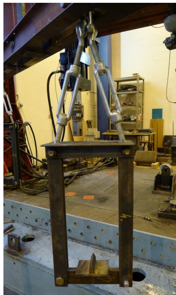
Obr. 6.34 Realizace zatěžovacího táhla
