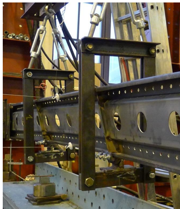
Obr. 6.42 Nosník vyztužený přičnými výztuhami
