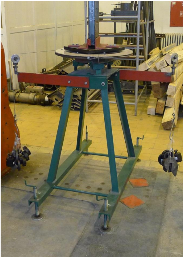
Obr. 6.6 Měřicí stůl s osazeným zkušebním tělesem
