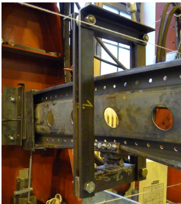
Obr. 6.41 Přičný ohyb pásnice v místě vnášení zatížení
