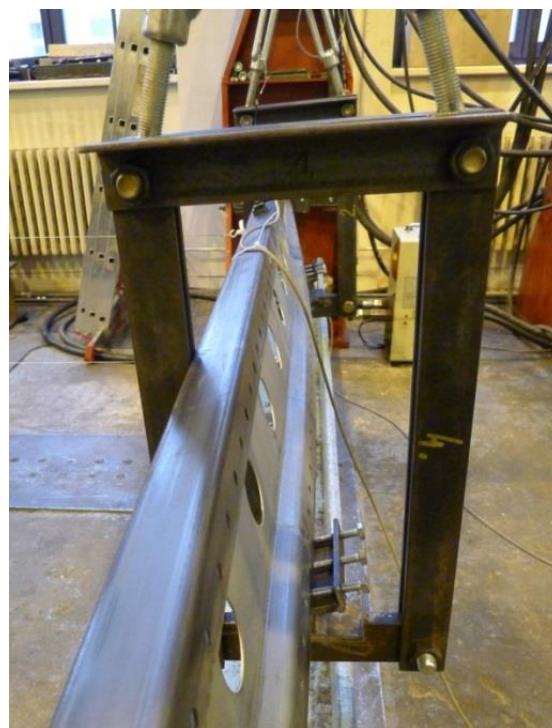
Obr. 6.40 Kontakt zkušebního tělesa s rámem táhla
