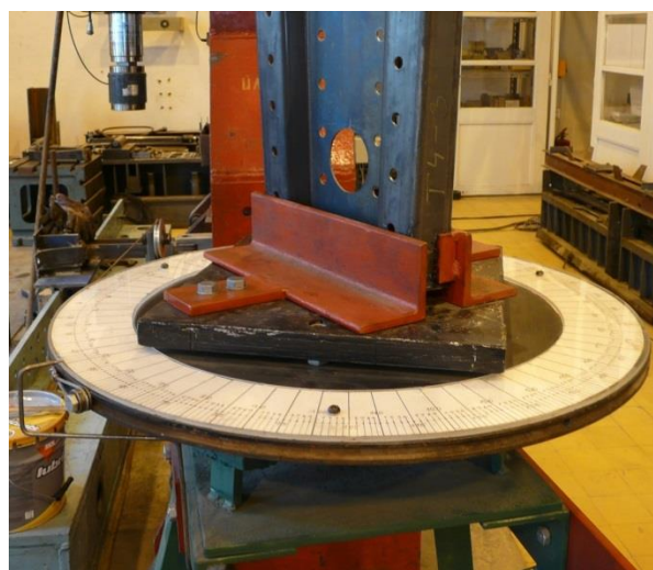
Obr. 6.10 Zatěžovací kotouč s unášecím pouzdrem
