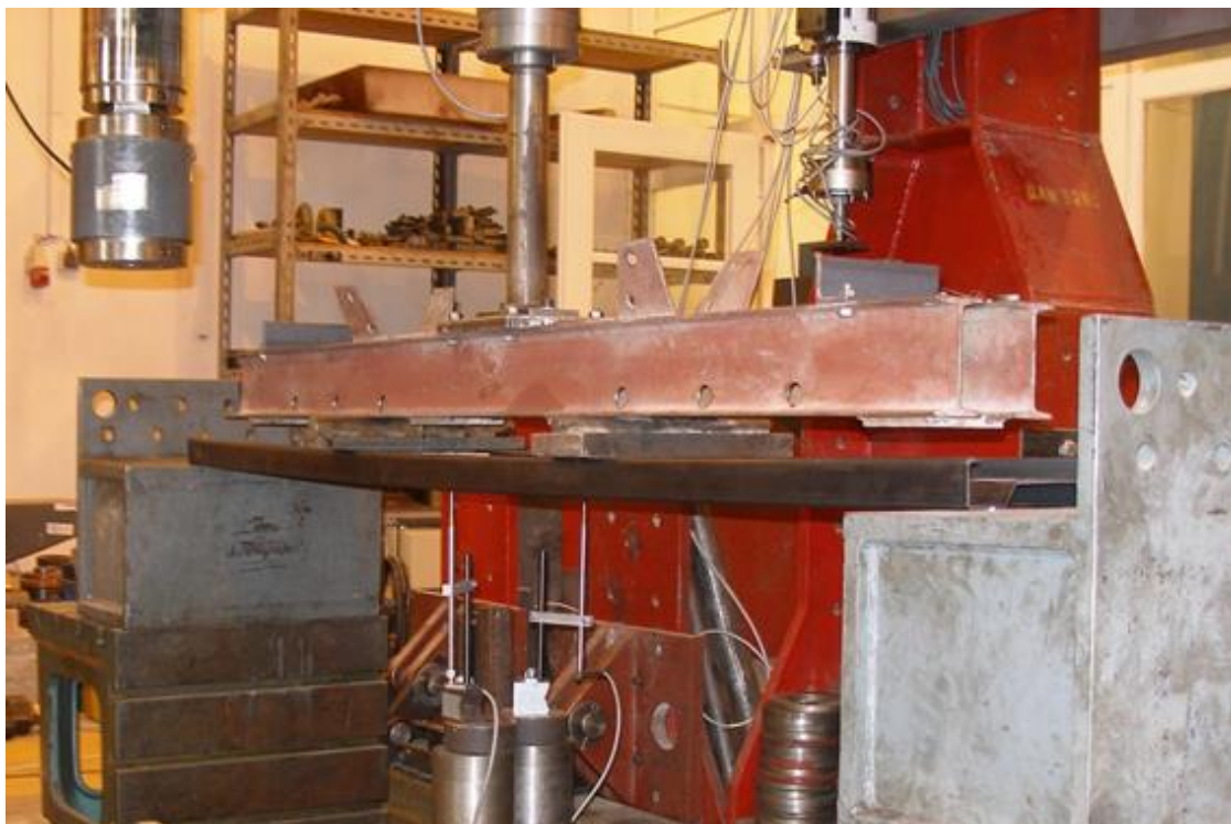
Obr. 6.25 Zkušební sestava pro ohyb na měkkou osu s nosníkem délky 2 m
