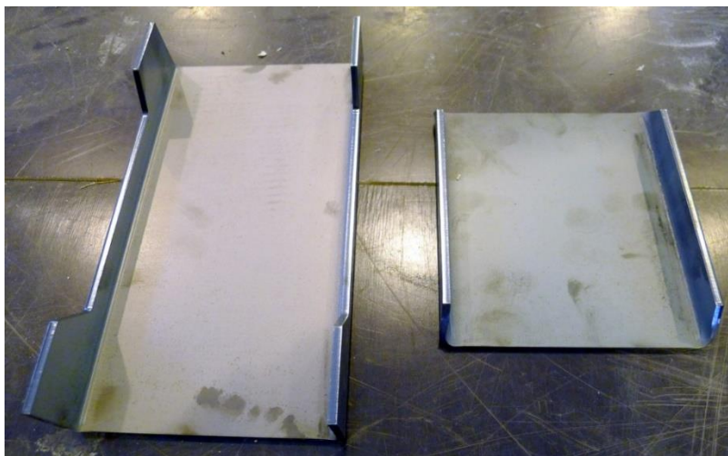
Obr. 6.12 Tvarované ohýbané plechy tloušťky 4 mm
