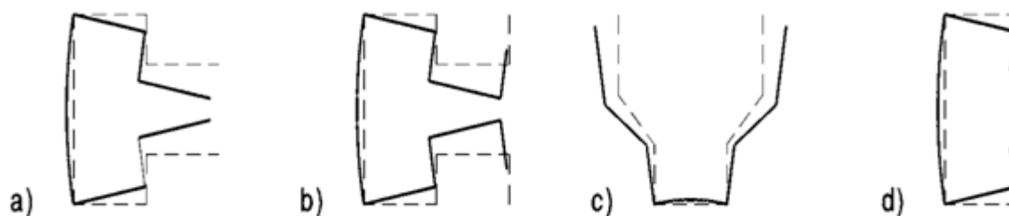
Obr. 2.13 Příkladů distorzního vzpěru vybraných tvarů průřezu
