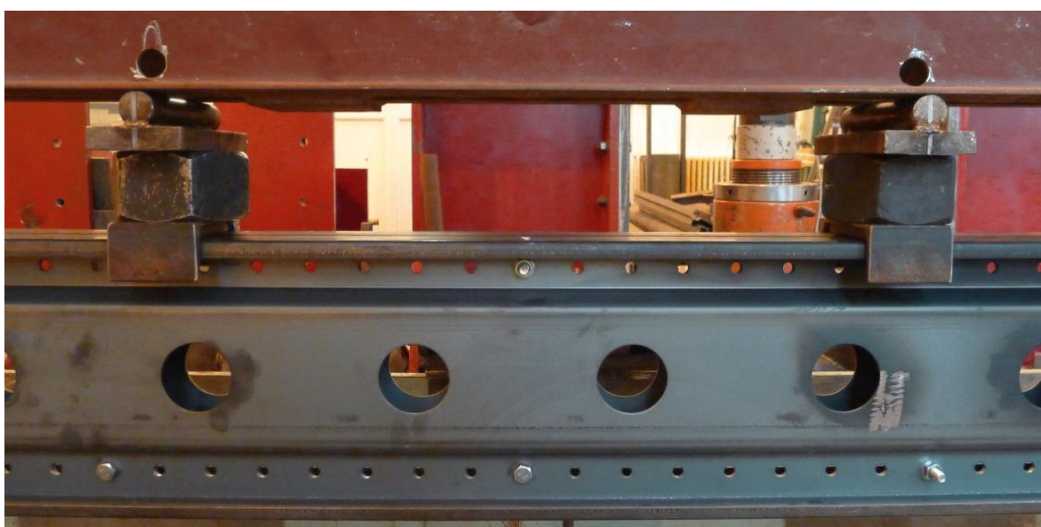
Obr. 6.19 Konstrukční řešení vnášení síly na dvojici nosníků
