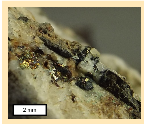
Obr. 25 Zrnka žlutohnědého sfaleritu v křemenné žilovině, vzorek č. 15.
