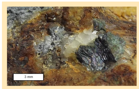
Obr. 26 Krystalek covellínu narůstající na kalcit, vzorek č. 76.
