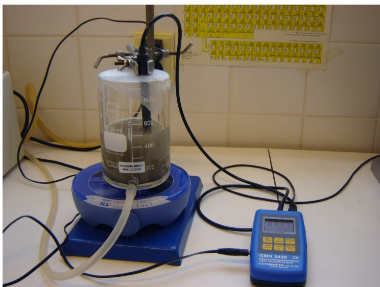
Obrázek 5) Detailní pohled na duplikátorovou kádinku s ponořenou konduktometrickou elektrodou napojenou na konduktometr. Pro zabránění kontaktu oxidu uhličitého ze vzduchu se zkoumaným roztokem je kádinka shora potažená parafilmem.
