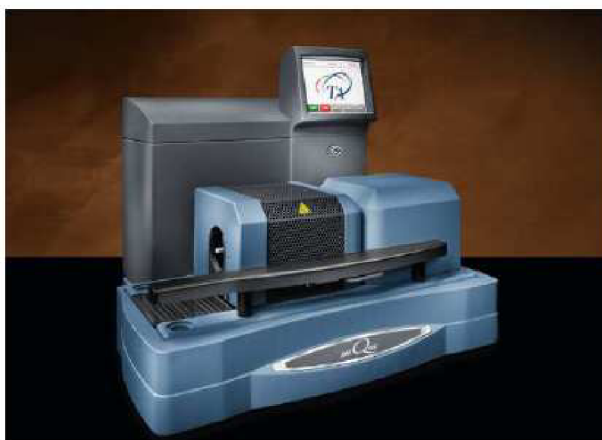
Obrázek 2) Přístroj (TG, DTA, DSC) TA Instruments Q 600 s horizontálním uspořádáním.
