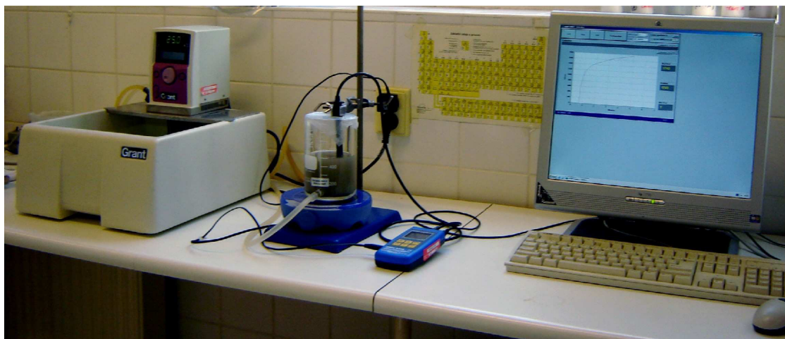
Obrázek 4) Celkový pohled na aparaturu pro měření vodivosti. Vlevo je vidět temperovaná vodní lázeň s termostatem, uprostřed je duplikátorová kádinka s měřenou směsí a ponořenou konduktometrickou elektrodou napojenou na konduktometr a vpravo je monitor od počítače se záznamem dat.
