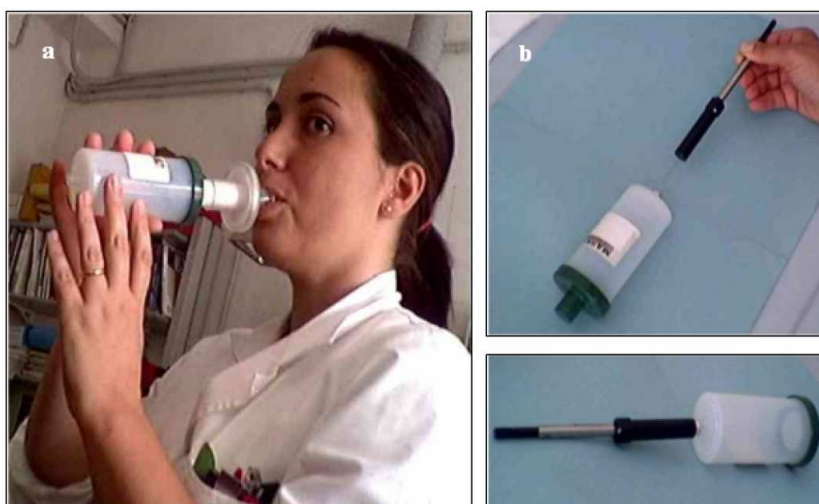
Obr. 6 Extrakce vydechovaných VOC metodou SPME (150 ml, 75 mm Carboxen, 30 min)
