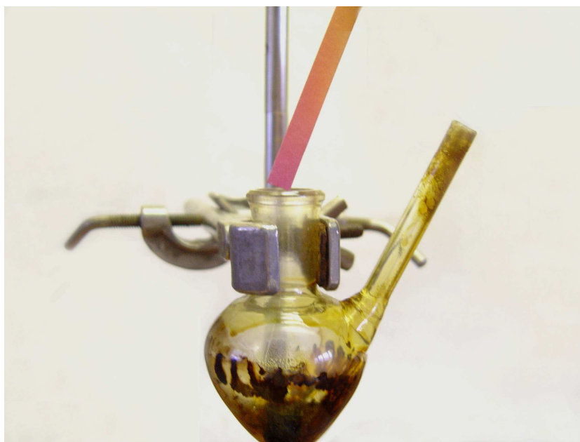
Obr. 12 Uvolňující se chlorovodík při termickém rozkladu PVC
