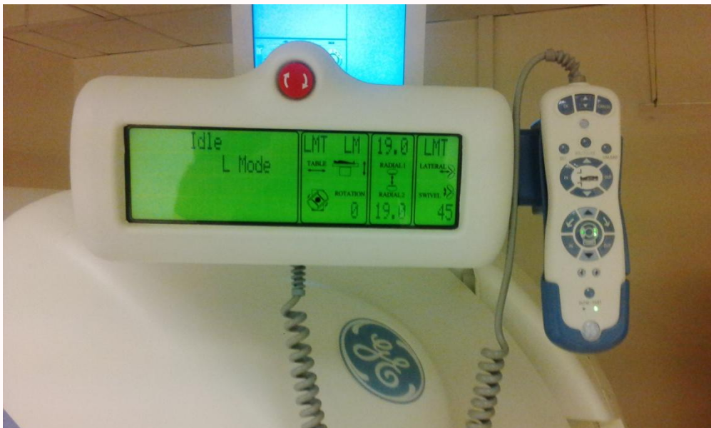
obrázok č.12 Diaľkový ovládač a displej s informáciami o pozícii hlavy detektora
