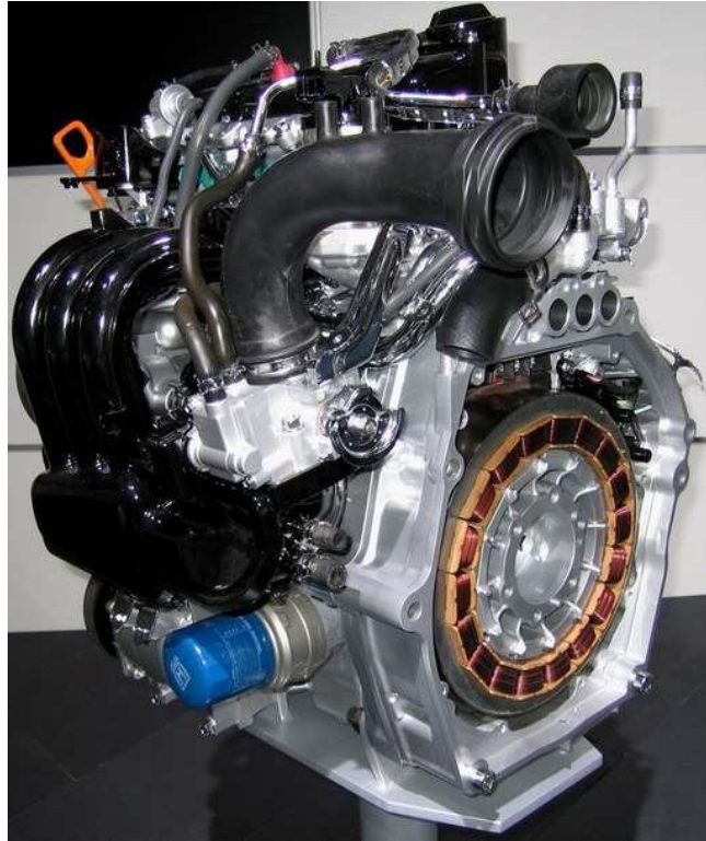
Obr. 9: Jednotka IMA první generace, mild hybrid [15]
