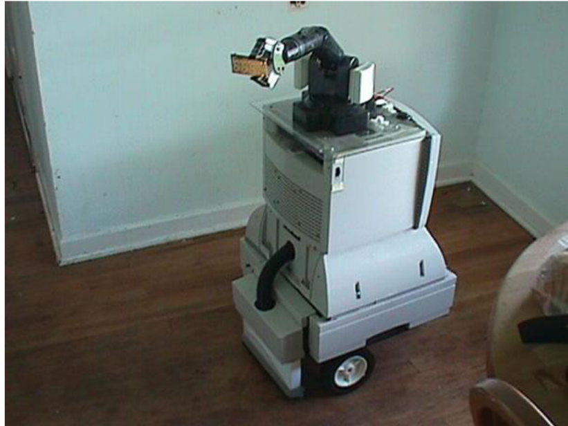
Obr. 4: Mobilní robot Max 97 – robotický vysavač [11]
