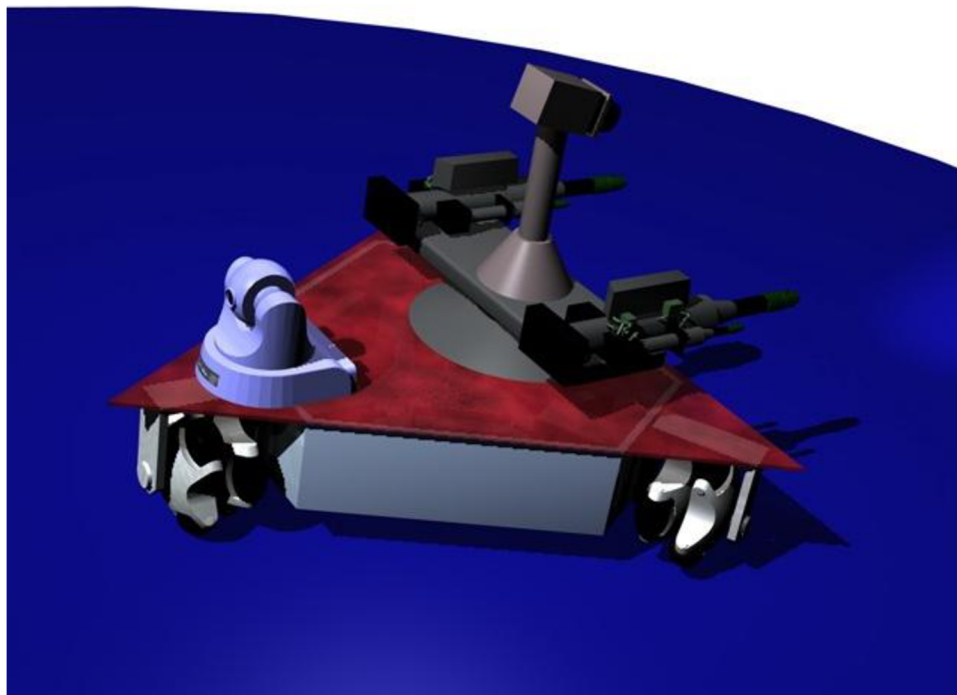
Obr. 7: Model tříkolového robota s všesměrovými koly
