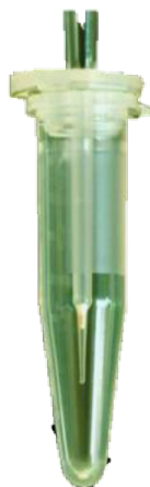
Obr. 10. Metoda \mu SPE-TP – Stage-Tip kolona obsahující SPE disky C18 (3x)/SDB-XC (3x).
