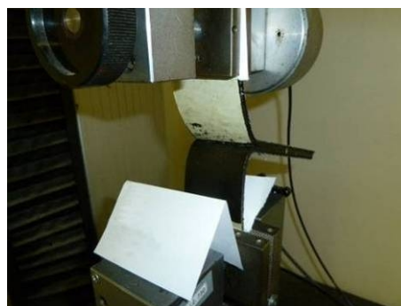
Obr. 54: Průběh zkoušky odolnosti proti odlupování ve spojích [79]
