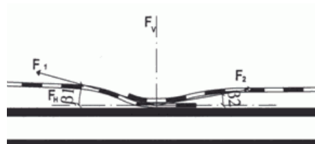
Obr. 66: Převažující lineární - smykové síly na odtržení [11]
