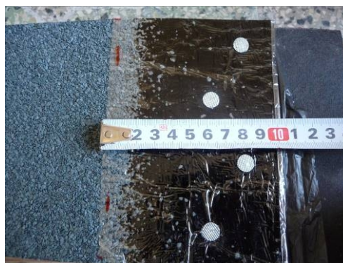
Obr. 156: Zkušební těleso kotvené hřebíky
