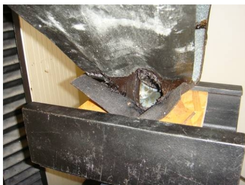
Obr. 152: Počáteční rozlepení spoje v okolí přítlačné podložky vzorku GP
