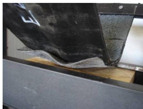
Obr. 98: Spolupůsobení separačního pásu s hydroizolačním povlakem
