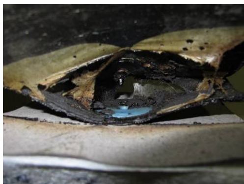
Obr. 164: Roztržení nosné vložky dolního pásu vzorku OX
