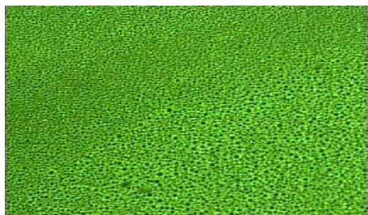
Obr. 11: Vynikající disperze APP modifikátoru v asfaltové hmotě (100x zvětšeno) [79]
