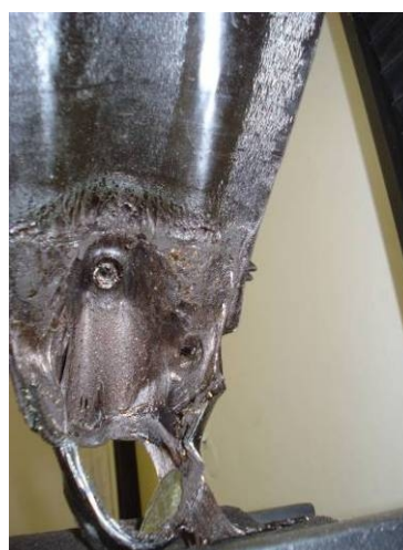
Obr. 102: Odtržení povlaku od podkladu a deformování podložky
