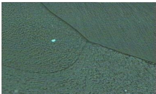
Obr. 9: Velmi dobrá disperze SBS modifikátoru v asfaltové hmotě (100x zvětšeno) [79]
