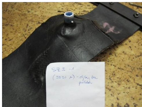
Obr. 187: Detail poškození teleskopu zkušebního tělesa SZ3-1
