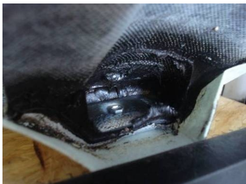
Obr. 94: Održení horního pásu od podložky kotevního prvku v počáteční fázi zkoušky tělesa D
