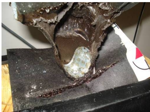
Obr. 104: Elastická deformace dolního pásu po přetrhnutí nosné vložky
