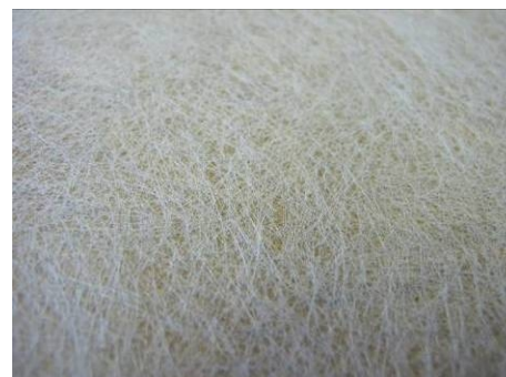
Obr. 14: Nosná vložka ze sklené rohože
