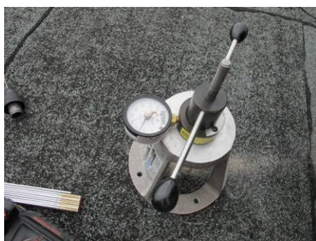
Obr. 38: Provádění výtažných zkoušek in situ
