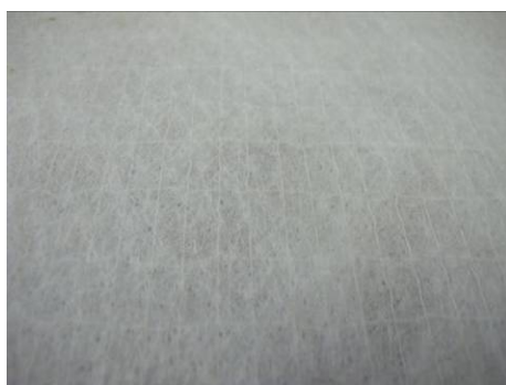
Obr. 19: Spřažená nosná vložka - PES rohož s obousměrným vyztužením skleněnými vlákny
