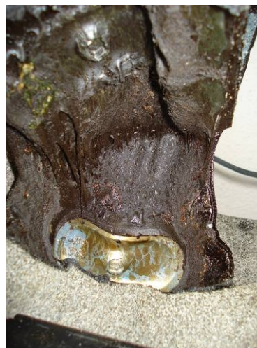
Obr. 86: Rozlepení spoje s mírnou deformací přítlačné podložky
