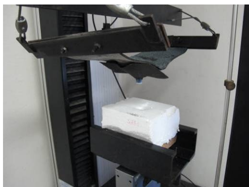
Obr. 180: Prasknutí teleskopu během zkoušky zkušebních těles SZ1
