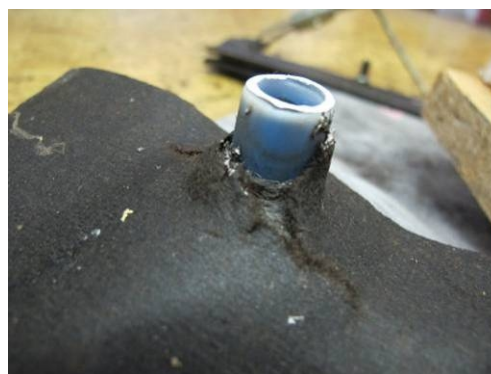
Obr. 181: Detail poškození teleskopu
