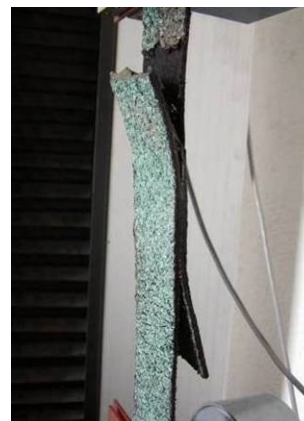
Obr. 56: Průběh zkoušky smykové odolnosti ve spojích [79]
