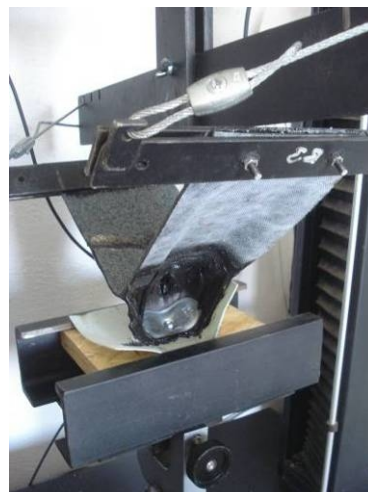
Obr. 95: Deformace přítlačné podložky a rozlepení větší části spoje
