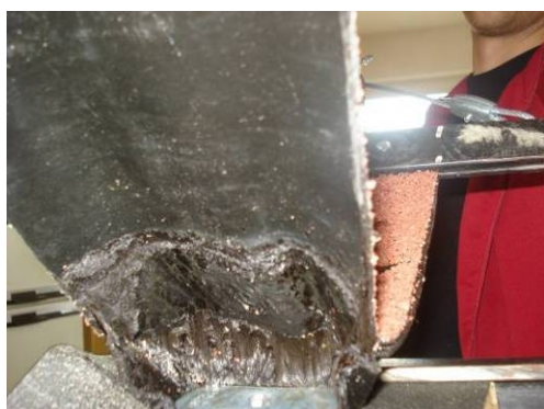
Obr. 91: Poškození spoje bez deformace kotevního prvku
