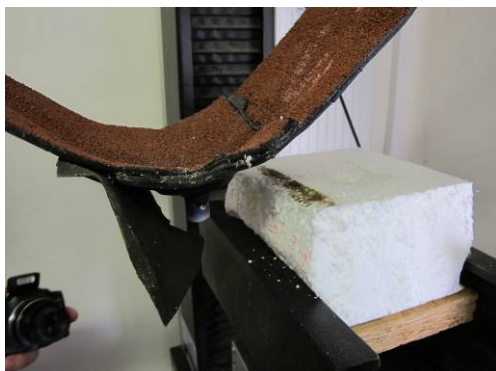
Obr. 186: Prasknutí teleskopu během zkoušky zkušebních těles SZ2+SZ3
