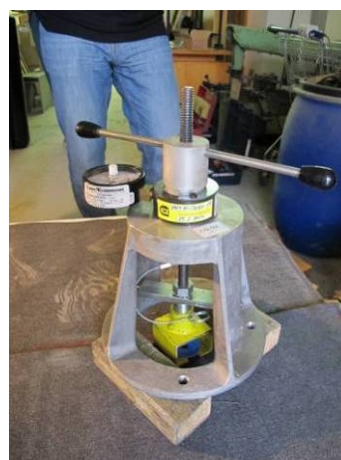
Obr. 39: Výtažné zkoušky v laboratorních podmínkách
