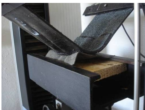
Obr. 97: Zkušební těleso E10 – při maximálním namáhání není patrné porušení spoje
