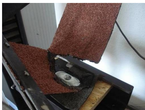
Obr. 92: Rozlepení spoje bez deformace kotevního prvku u vzorku C
