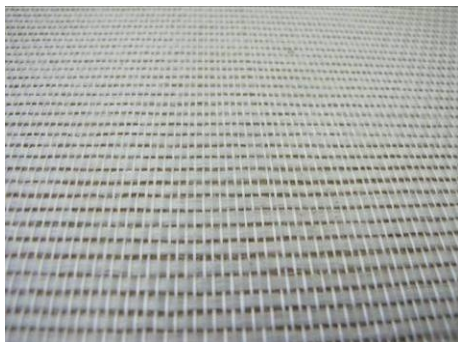
Obr. 15: Nosná vložka ze skleněné tkaniny
