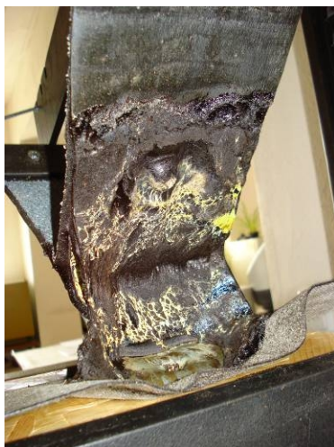
Obr. 85: Výrazné rozlepení spoje u zkušební vzorku A
