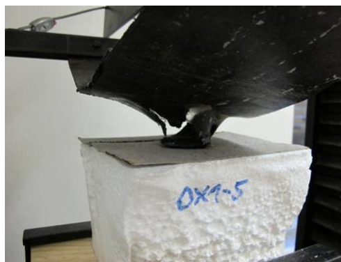
Obr. 165: Odtržení povlaku od podkladu
