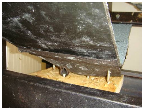
Obr. 161: Poškození vzorku EH a FH
