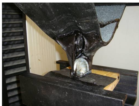
Obr. 153: Odtržení povlaku od podkladu a deformování podložky
