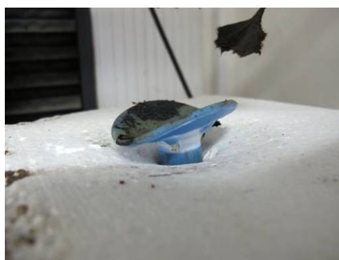
Obr. 189: Detail poškození teleskopu během zkoušky zkušebních těles SZ2+SZ3
