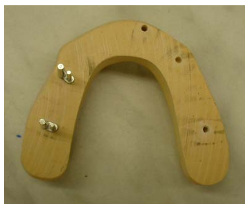
Obrázek 21 Zavedení vodících čepů
