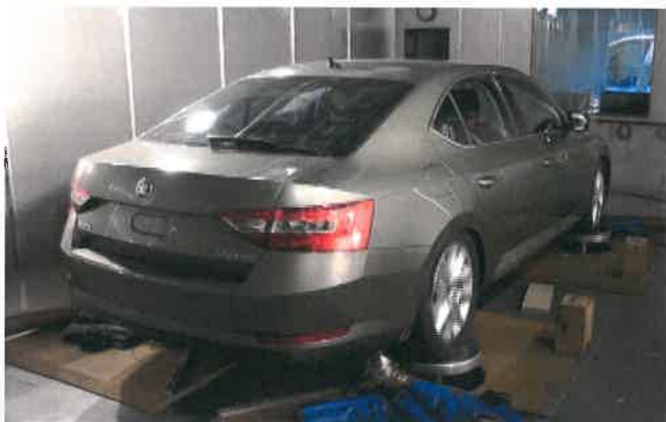
Obr. 2 4-kanálový simulátor vozovky MTS
