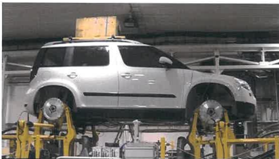
Obr. 1 16-kanálový simulátor vozovky MTS
