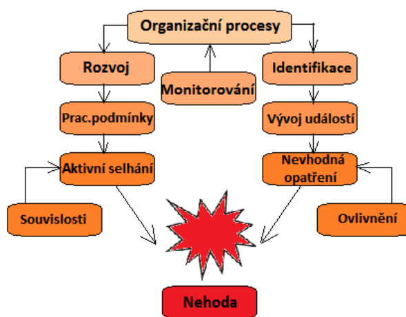
Obr. 7 - Schéma nehody způsobené organizačním faktorem, Zdroj: Safety management manual
