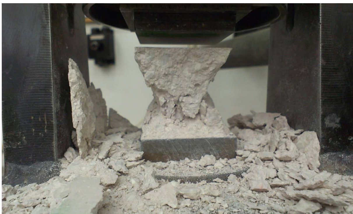
Obr. 22 Zkušební těleso po zkoušce pevnosti v tlaku
