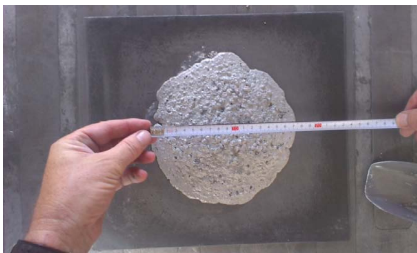
Obr. 16 Stanovení konzistence po roztečení kužele
