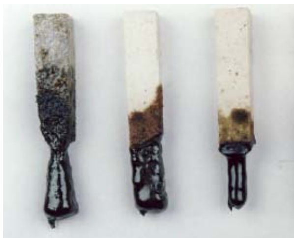
Obr. 6 Trámečková ponořovací statická metoda, vzorky po zkoušce
