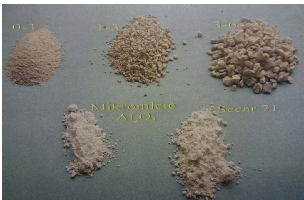
Obr. 10 Použité frakce páleného kaolinu, mikromleté Al 2 O 3 , hlinitan. cement Secar 71
