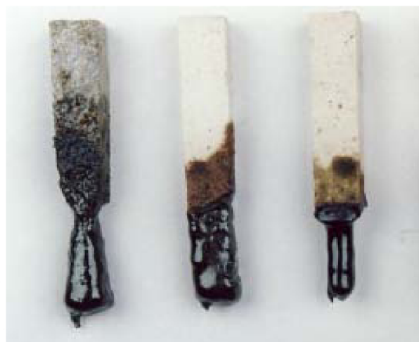
Obr. 6 Trámečková ponořovací statická metoda, vzorky po zkoušce
