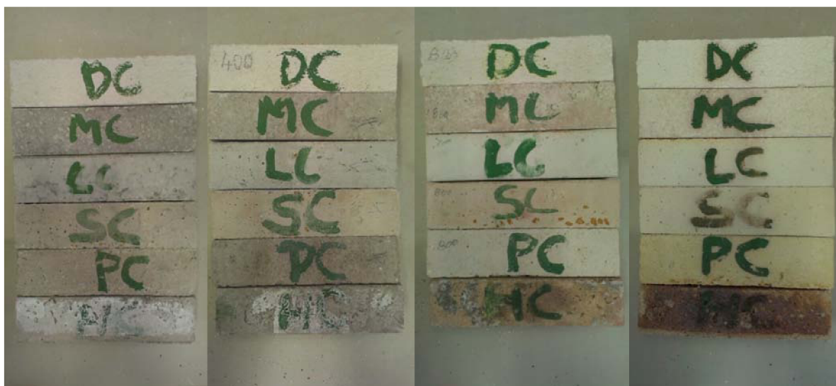
Obr. 12 Zkušební vzorky po vysušení, vypálené na 400, 800 a 1200°C
