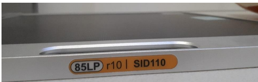
Obrázek 10: Protirozptylová mřížka fokusovaná pro vzdálenost 110 cm (zdroj vlastní)
