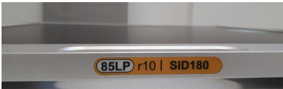
Obrázek 11: Protirozptylová mřížka fokusovaná pro vzdálenost 180 cm (zdroj vlastní)
