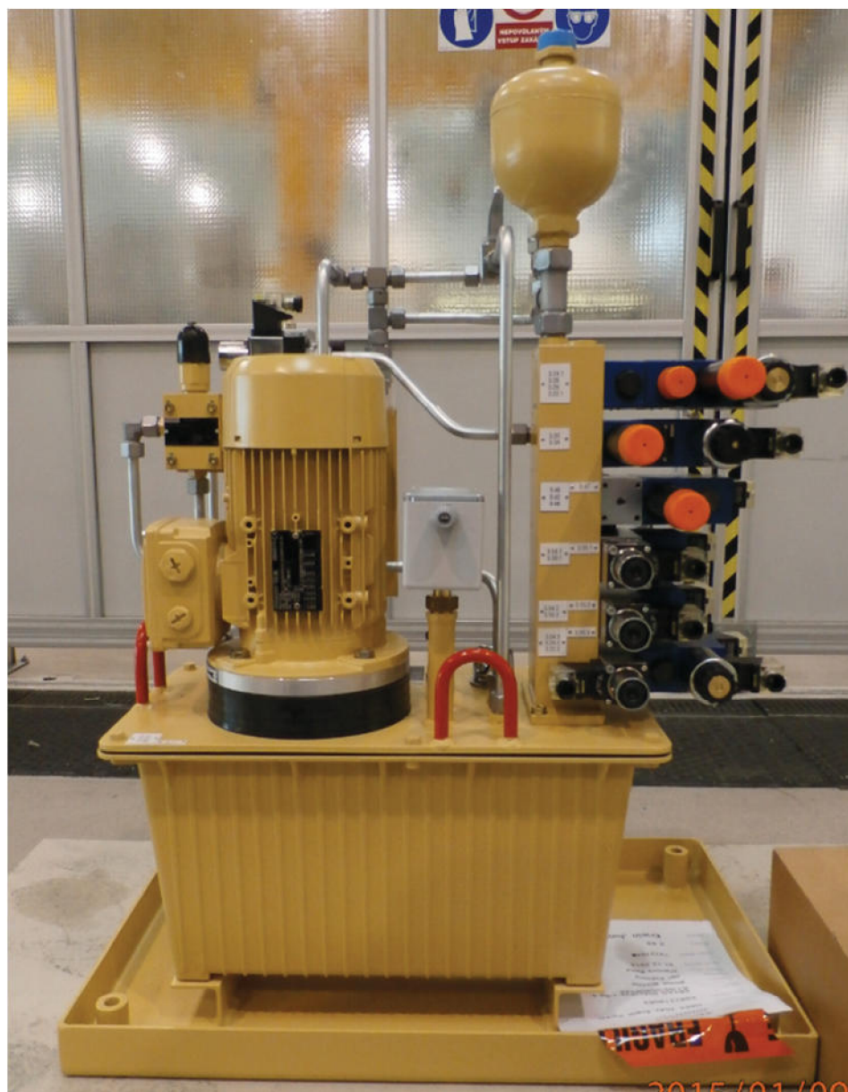
Obr. 5 Agregát velikosti S (objem nádrže: 20 litrů) [9].
