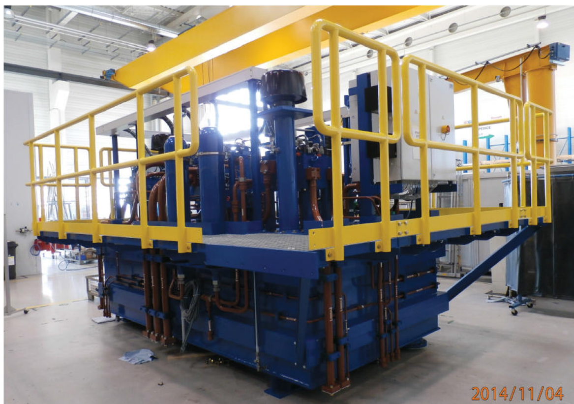
Obr. 7 Agregát velikosti XL (objem nádrže: 12 000 litrů) [9].
