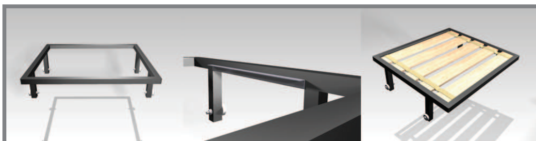
Obr. 22 Konstrukce sedáku – rám, plech, rošt
