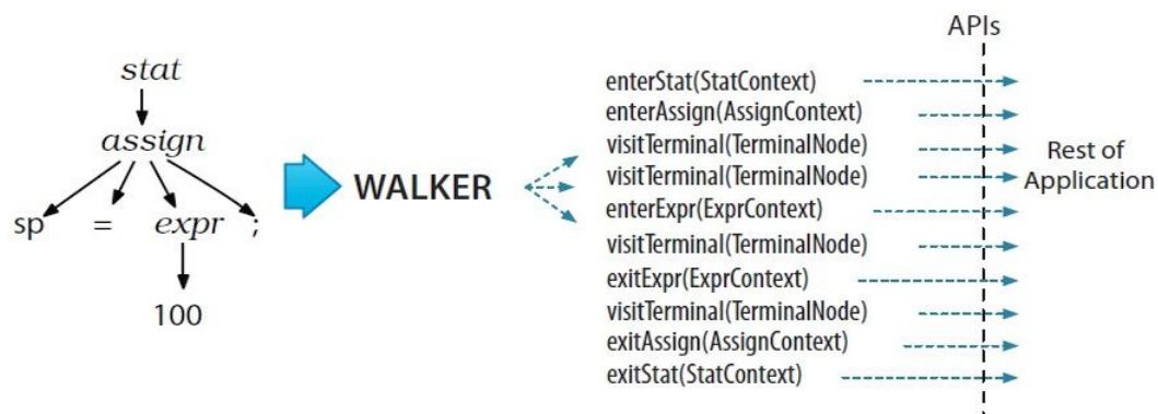
Obrázek 7.2: Ilustrace volání metod třídy listener při průchodu walkeru. Převzato z [20]
