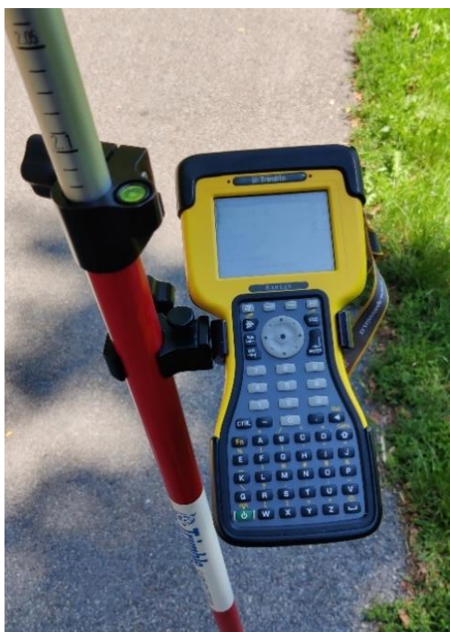
Obrázek 3.4: Kontrolní jednotka Trimble Ranger (vlastní)
