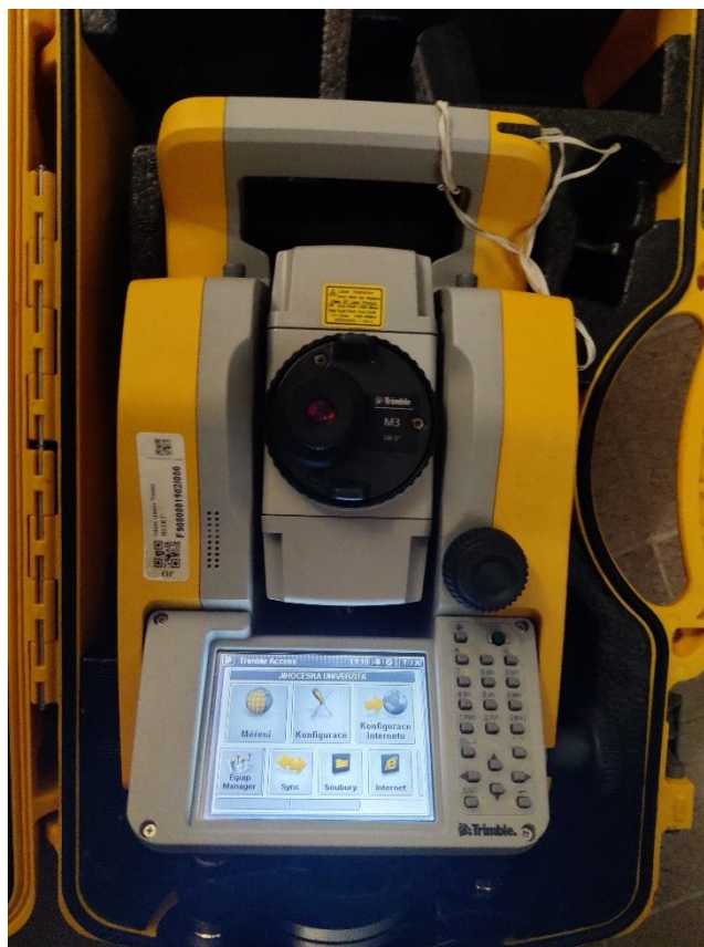
Obrázek 3.2: Totální stanice Trimble M3 (vlastní)
